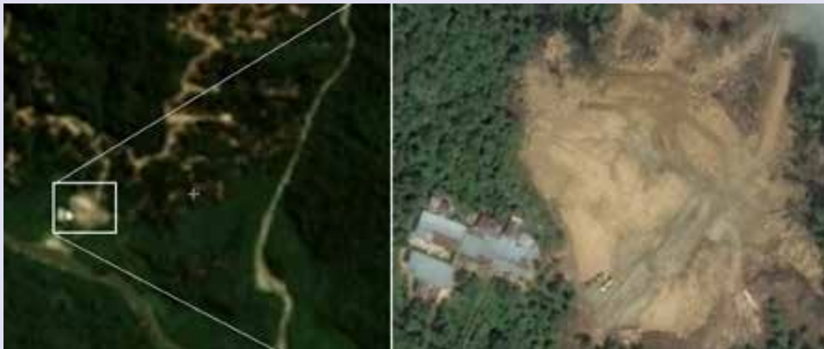
Gauche: Image Landsat 8 de 15m de résolution montrant la construction récente d'une route et une exploitation sélective intense. Droite: Image Worldview 2 de 50cm de résolution d'une partie de la même zone indiquant la présence de bâtiments, de véhicules et de grumes individuelles.
